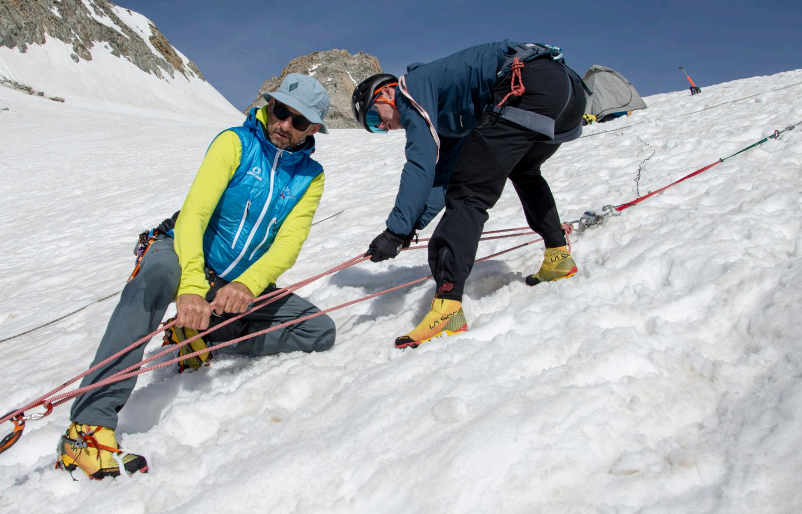
Figure 1: Mesure des efforts exercés sur le point d'ancrage lors d'un mouflage. Un dynamomètre est fixé sur le point d'ancrage.
