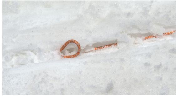
Figure 15: Nœuds ancrés dans la neige à la suite d'une chute (Gym à gauche et Radline à droite).
