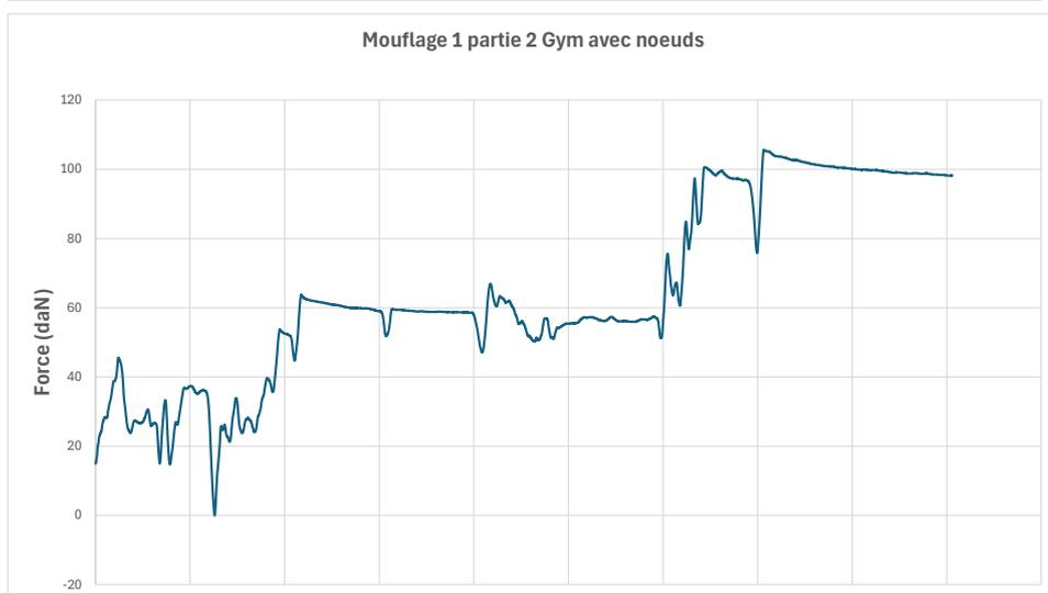
Figure 10: force sur le point d'ancrage avec un mouflage simple en fonction du temps avec une corde Gym et des noeuds, la force augmente au cours du mouflage pour atteindre 100daN. .
