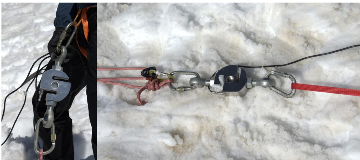
Figure 3: Capteur de force placé sur le pontet (image de gauche) ; Capteur de force placé sur le mouflage (image de droite).
